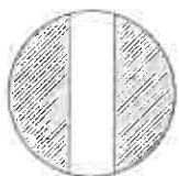
Fig. 3. — Aspect du champ dans le Photomètre V. B. Y. Pour une mesure, il faut réaliser l'égalité d'éclairement de la plage centrale et des 2 plages encadrantes.
